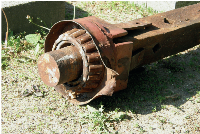
Zrezivělé ložisko korouhve, rok 2008
